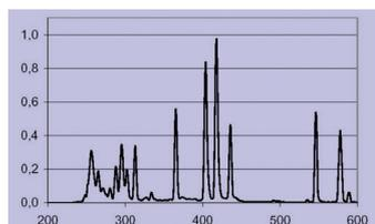
Spectres standard des lampes UVASPOT 400/T (longueur d'onde en nm, intensité en unités relatives)
