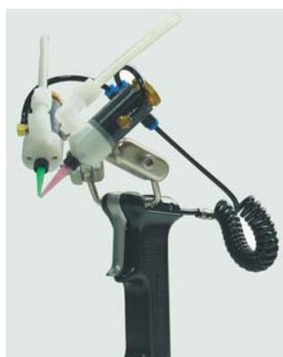
Pistolet de dépose par superposition, faible maintenance, réglage des débits incorporés.
